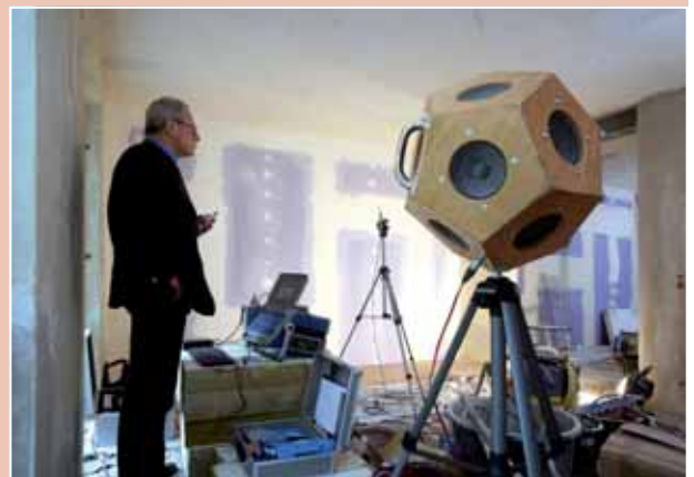
Messungen bestätigen die Wirksamkeit der Knauf Vorsatzschale mit Diamant zur schalltechnischen Verbesserungen von Wohnungstrennwänden.
